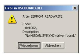
Diese Meldung erscheint, weil noch kein Scanner eingerichtet wurde. Das Einrichten des Scanners ist auch der erste Schritt:
